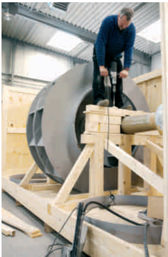
Упаковка отремон- тированного двухпо- точного ротора на деревянном трансп- ортировочном каркасе для надеж- ной перевозки
