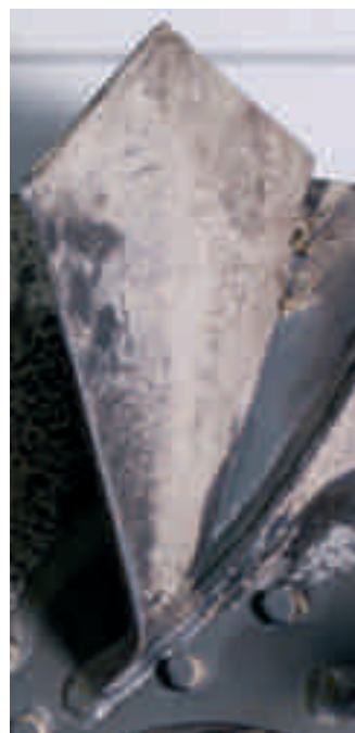
Крыльчатка, эксплуатируемая в деревообрабатывающей промышленности, с явным износом, частично с оторванными или надорванными лопастями
