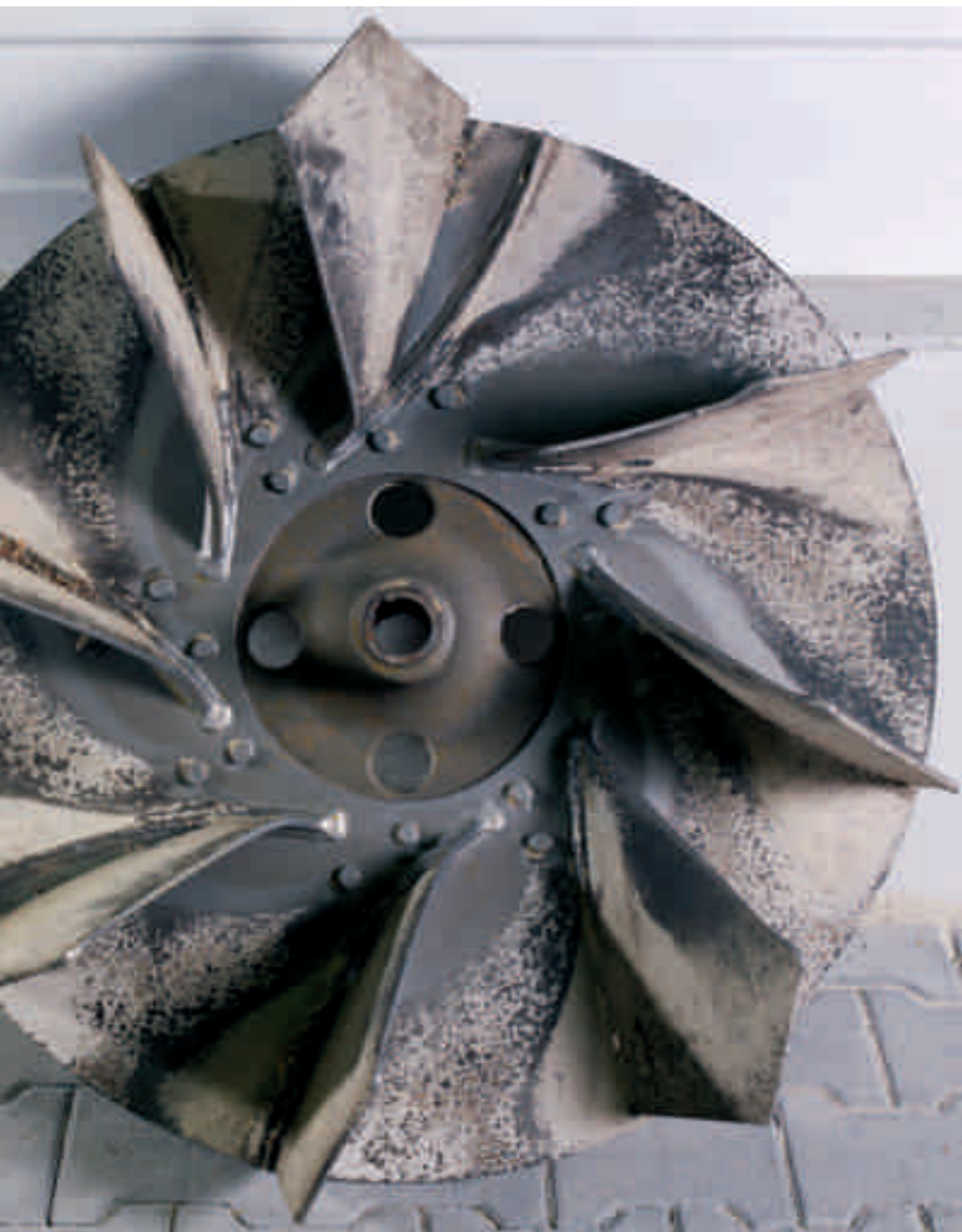
Крыльчатка, эксплуатируемая в деревообрабатывающей промышленности, с явным износом, частично с оторванными или надорванными лопастями
