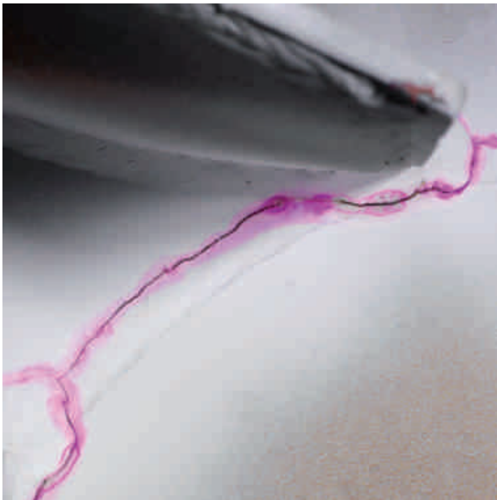
Анализ повреждений/ контроль трещин краско- капиллярным методом в области усилительного конуса – место соедине- ния с задним диском
